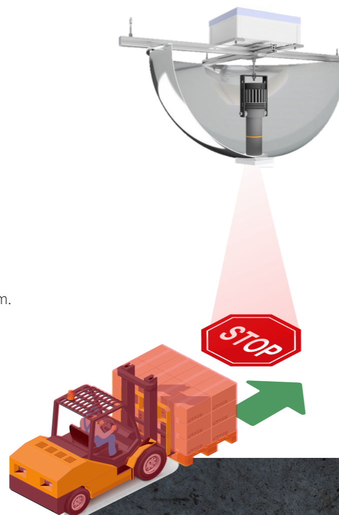
detekce směru příjezdu VZV k parabolickému zrcadlu
