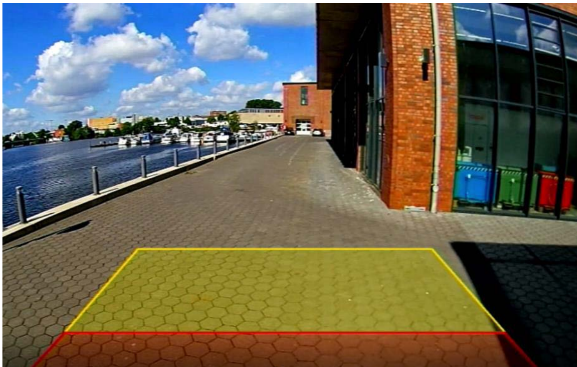
Obr. 6 Výstražná oblast kamery na monitoru
